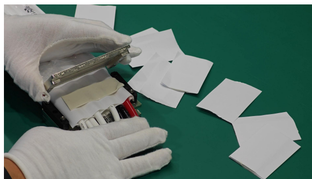
第一层与压线板安装
